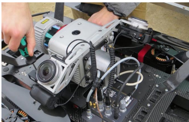
Rys. 1. Widok na spód drona – skaner laserowy LiDAR oraz kamery wysokiej rozdzielczości (źródło: [5])
